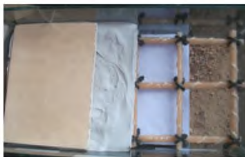
Рис. 3 – Изготовление макета с применением композитной арматуры
